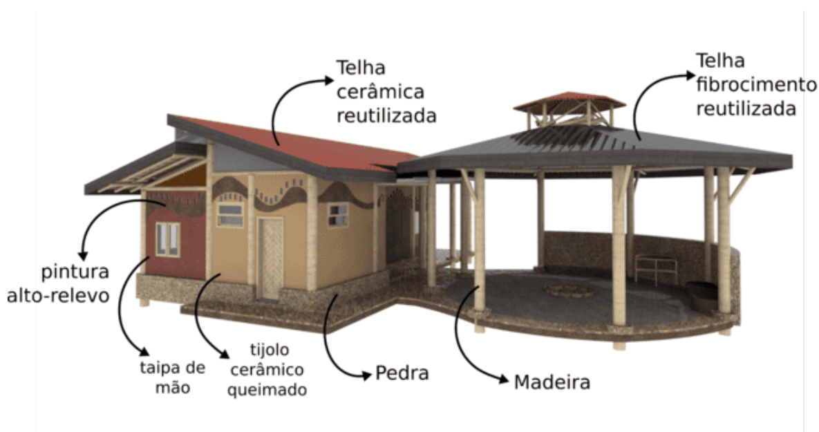
Figura 1: Perspectiva de maquete eletrônica do projeto apontando os principais materiais e técnicas utilizadas.
