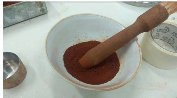
Figura 2. Solo destorroadado manualmente
