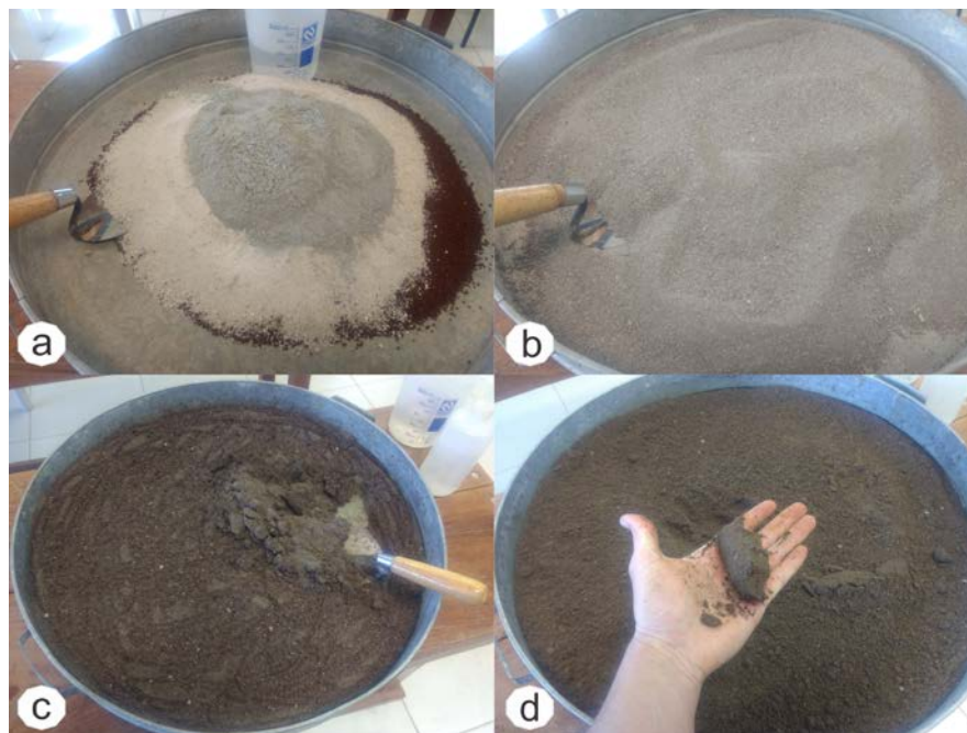
Figura 3. Procedimento de mistura do solo-cimento: (a) solo com 15% de cimento, (b) mistura do solo-cimento seco, (c) adição de água em uma mistura homogênea, e (d) solo-cimento pronto para moldagem dos corpos de prova.
