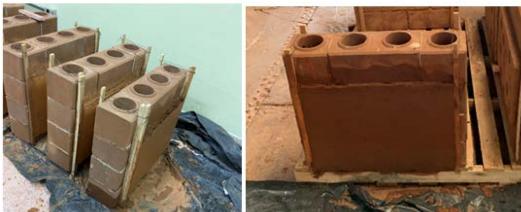
Figura 3. Mini-painéis de blocos vazados de solo-cimento revestidos de argamassa de solo-cimento
