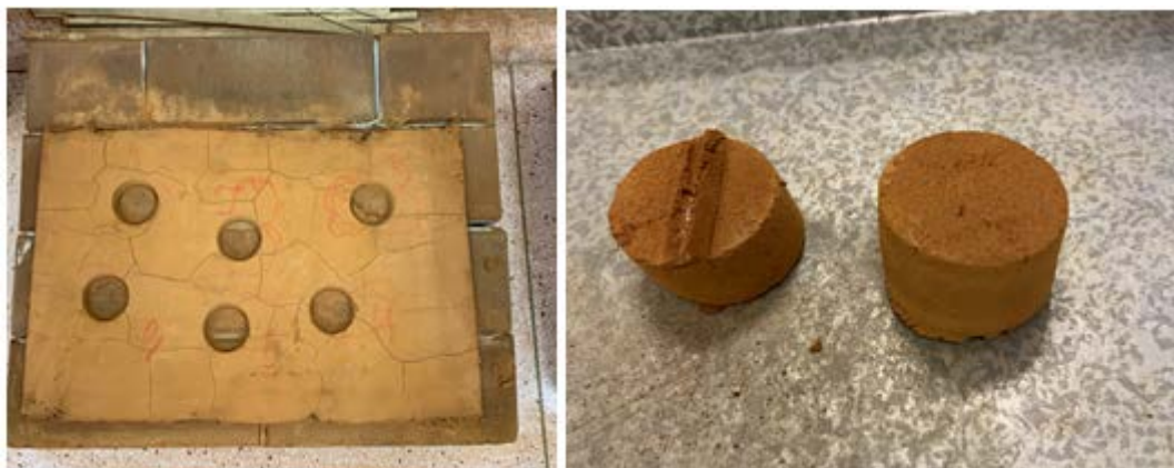
Figura 6. Ruptura interface argamassa/substrato
