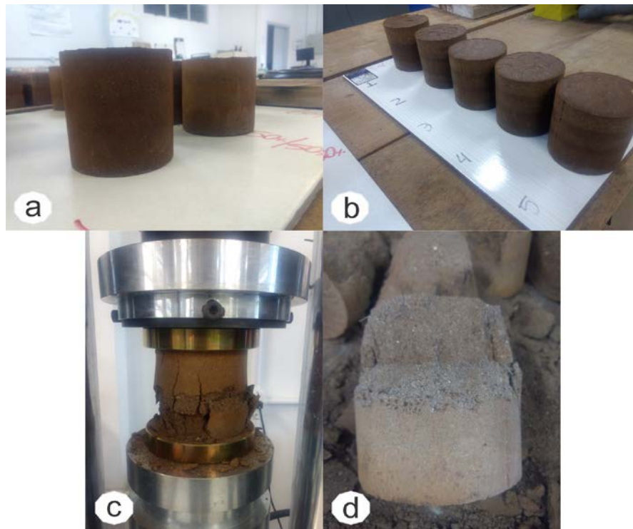
Figura 4. Corpos de prova elaborados para o ensaio de resistência mecânica: (a) após desmoldagem, (b) em processo de cura, (c) durante o rompimento, e (d) após o rompimento
