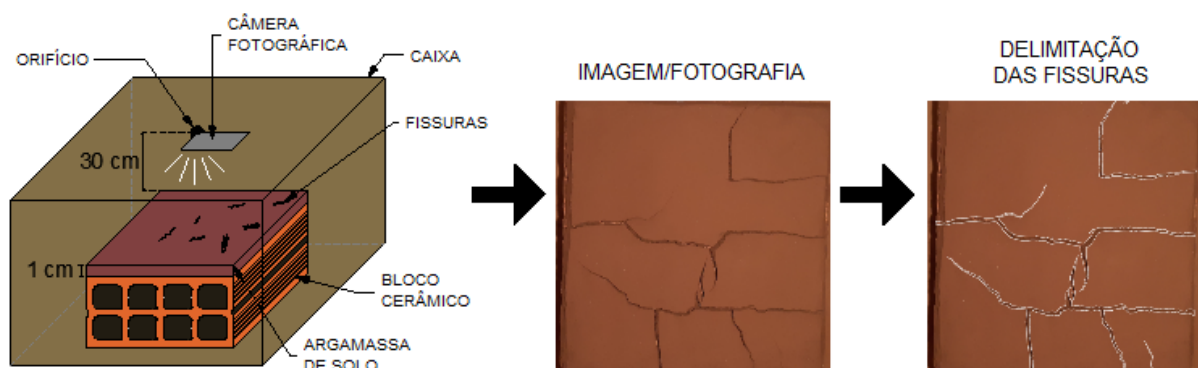
Figura 2 - Delimitação das fissuras em área (adaptado de Fujita, 2020)
