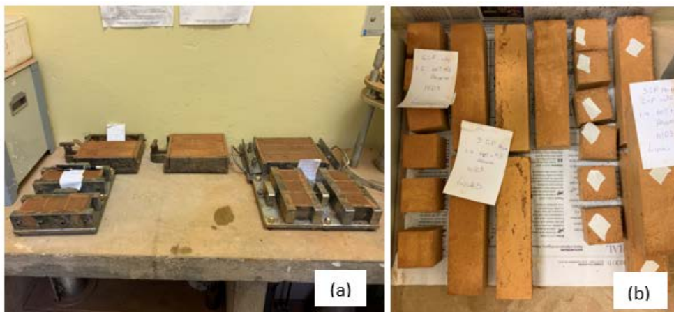
Figura 2. Corpos de prova prismáticos e cúbicos: (a) moldagem e (b) desmoldados
