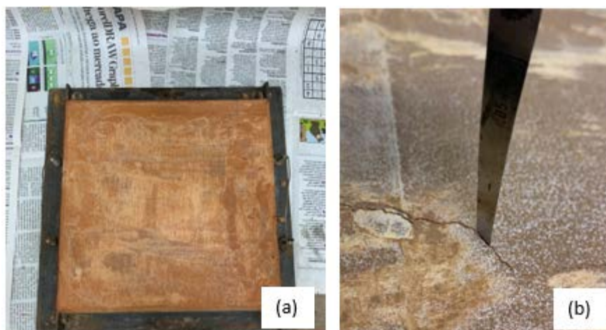
Figura 4. Argamassa de solo arenoso-cimento: (a) sem fissuração (b) fissura interna
