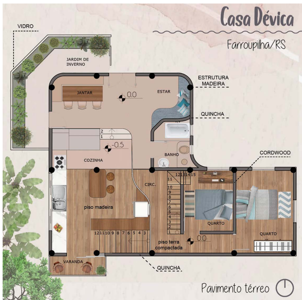
Figura 2: Planta baixa humanizada do pavimento térreo
