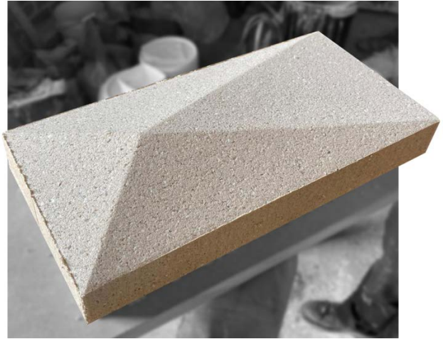
Figura 8. Módulo de revestimento "Peixes" produzido com vidro reciclado
