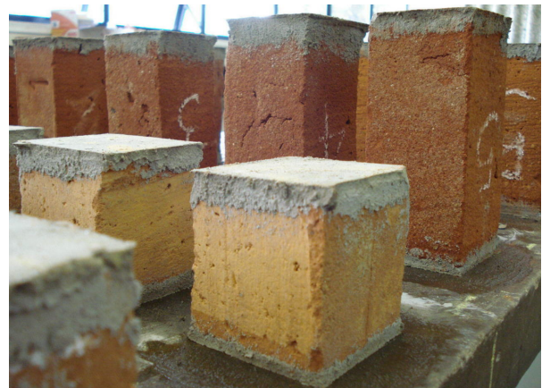
Figura 3. Corpos de prova cúbicos e prismáticos, preparados para os ensaios (crédito: C. Santos)
