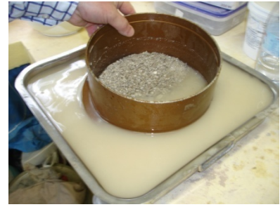
Figura 4.c - Lavagem da amostra
