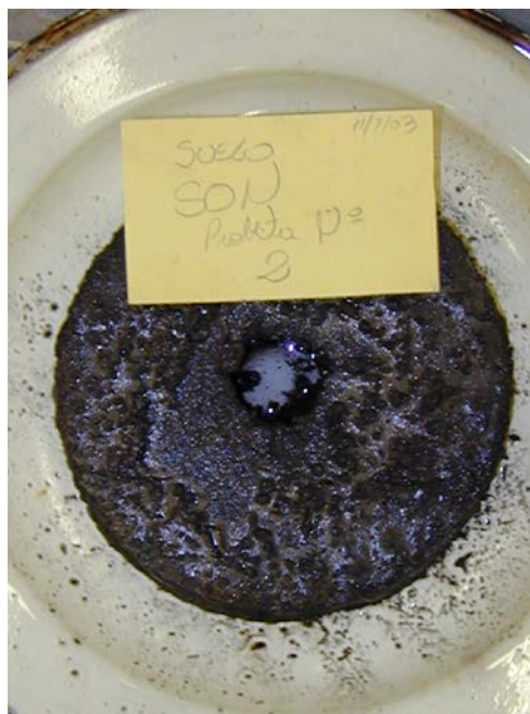
Figura 15 – Baldosa de suelo natural (final del ensayo)
