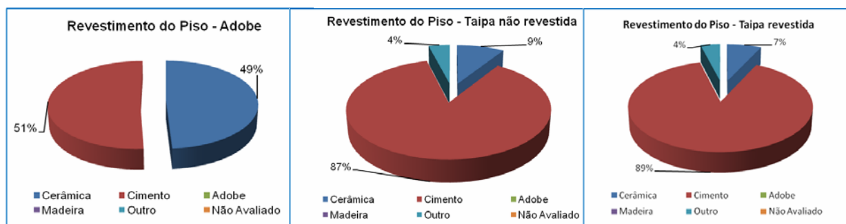
Figura 5 – Tipo revestimento de piso
