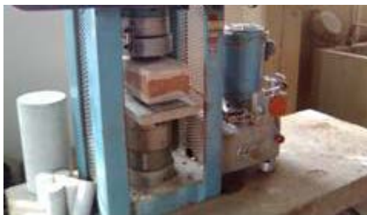
Figura 3 – Ensaio de resistência à compressão
