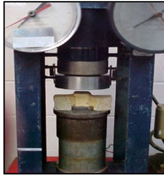
Figura 10 – Ensayo de adherencia
