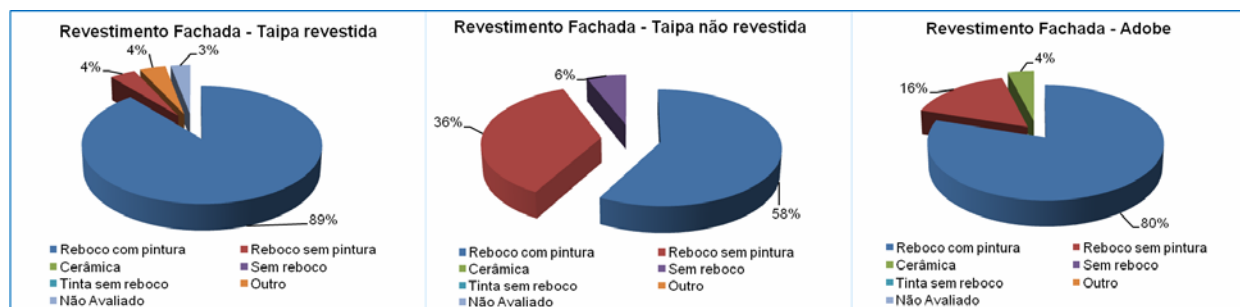
Figura 3 – Tipo de Revestimento da Fachada
