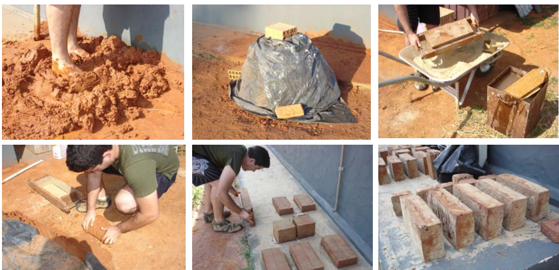
Figura 3 – Amassamento do barro e moldagem dos adobes e cubos.
