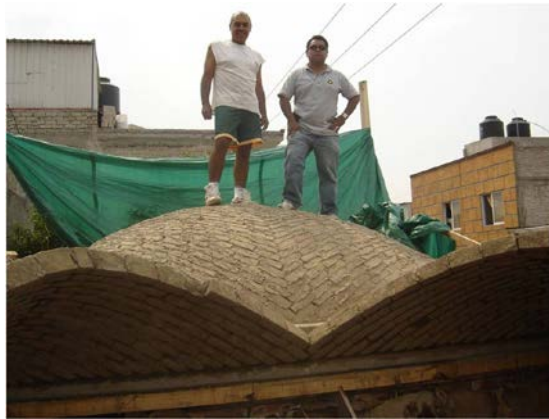
Figura 1 – Resistencia de Bóveda de adobe
