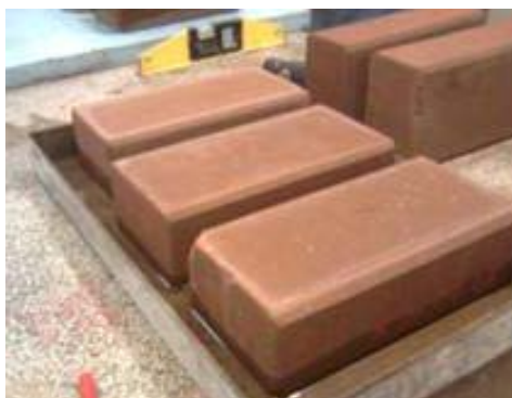
Figura 4 – Aspecto dos pisos com RCD
