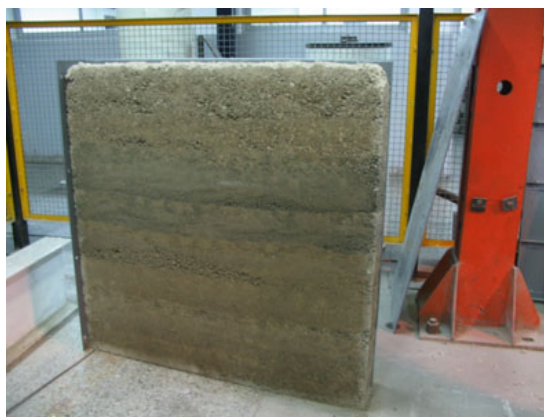
Figura 2 – Modelo constructivo de suelo-cemento con compactación manual
