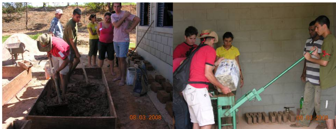
Figura 2 – Uma das etapas de produção dos adobes e dos BTCs (acervo do Projeto CRESCER)
