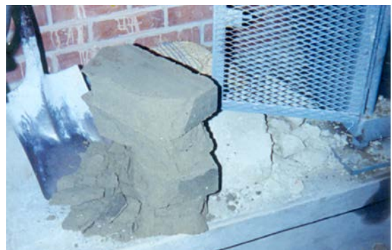
Figura 2 – BTC probados a compresión en estado húmedo. Foto: Rubén Roux
