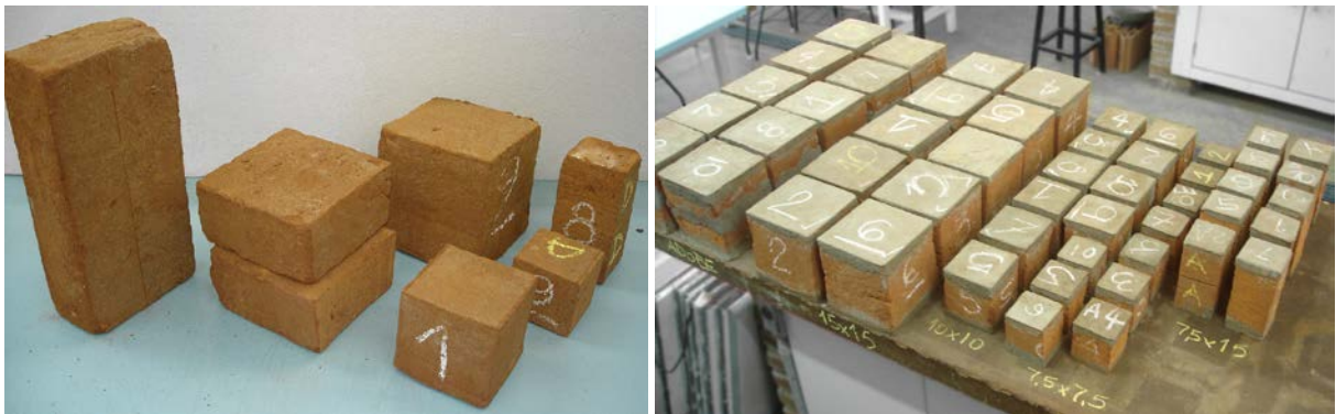
Figura 4 – Corpos-de-prova preparados, antes da ruptura.
