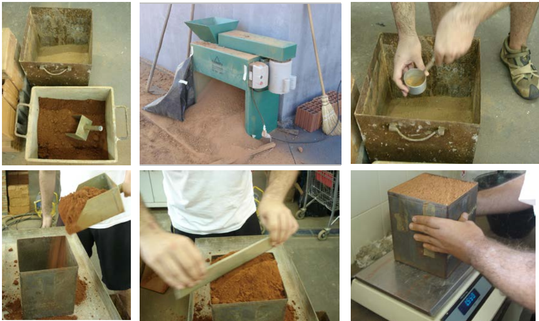
Figura 1 – De cima, no sentido horário: solos utilizados (Americana, mais claro e Bauru, mais escuro); destorreador de solos; coleta de amostras para determinação do teor de umidade natural; e, etapas do ensaio de determinação da massa unitária no estado solto.
