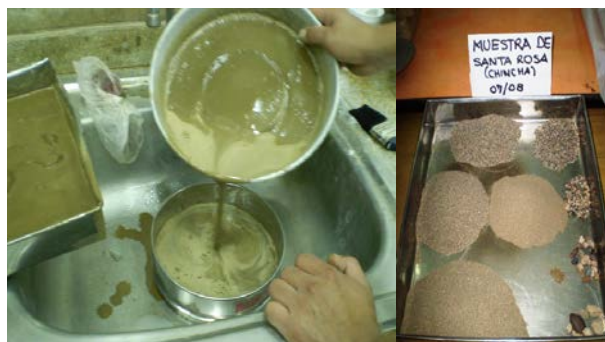
Figura 3 – Análisis por tamizado
