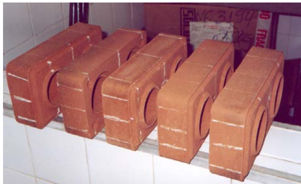
Figura 3 – Blocos marcados com giz para medição de sua variação dimensional
