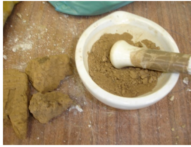
Figura 4.b - Moagem da amostra
