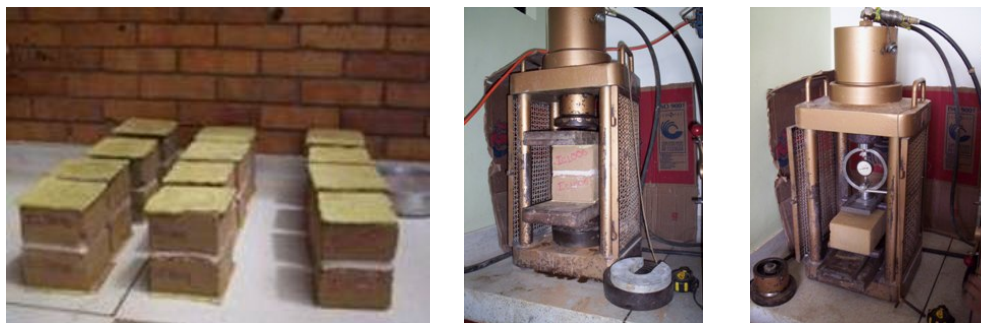
Figura 4 – Preparación de los bloques para la prueba de resistencia a la compresión.
