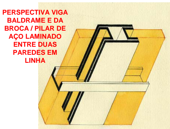
Figura 4 – Detalhe da viga baldrame x broça / pilar
