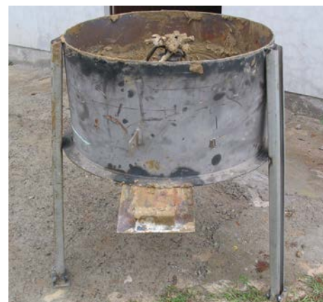
Figura 7 – Misturador de barro construído para dinamizar o processo de produção de adobes COOHAP São Leopoldo
