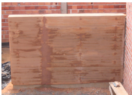
Figura 6 – Painel 2 restaurado com consolidante acrílico
