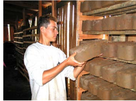
Figura 5 – Prateleira de secagem dos adobes-acústicos para cúpula no Centro de vivência Integria e COOHAP
