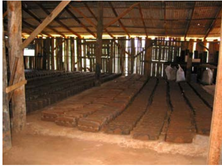
Figura 4 – Galpão de produção dos adobes para habitação prototípica e para Picada Café, COOHAP
