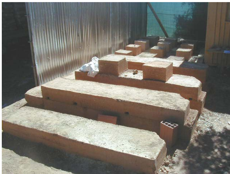
Figura 2 – Ensaio das várias misturas utilizadas para a realização da taipa
