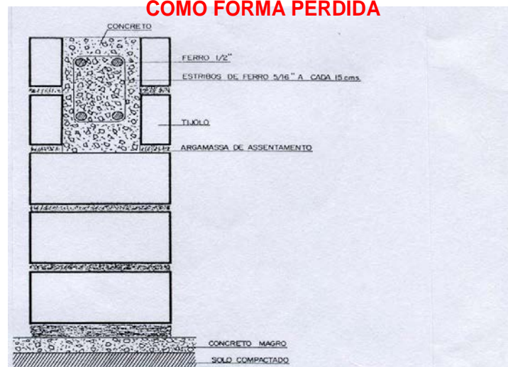
Figura 6 – Corte esquemático da viga baldrame
