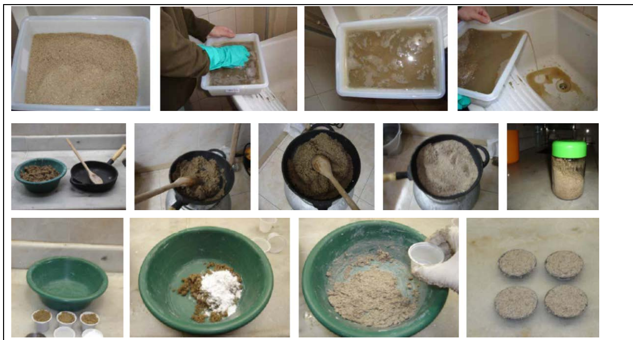
Figuras 3 – Experimentos com diversos tipos de solos para estudo sobre o desempenho das argamassas, para análise dos agregados e aglomerantes. Fonte: CECI/2006
