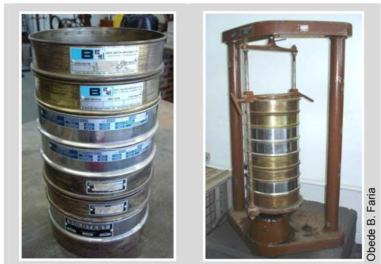
**Figura 2** – Ensaio de peneiramento: série de peneiras normal e equipamento elétrico para peneiramento
