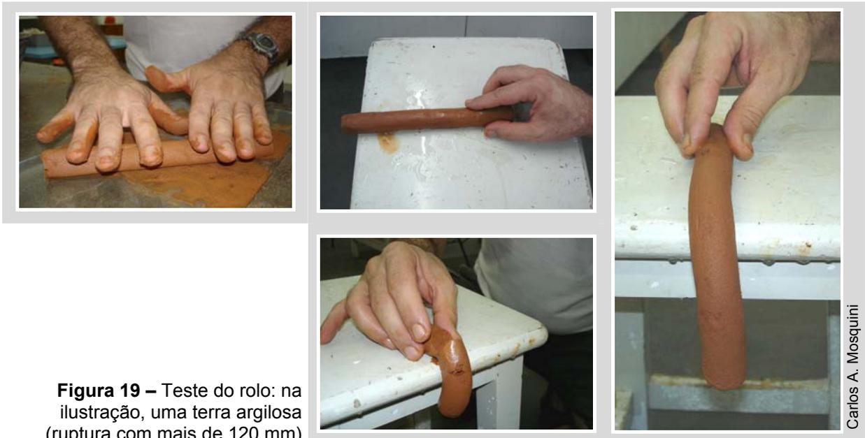
**Figura 19** – Teste do rolo: na ilustração, uma terra argilosa (ruptura com mais de 120 mm)
