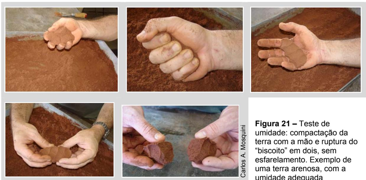
**Figura 21** – Teste de umidade: compactação da terra com a mão e ruptura do “biscoito” em dois, sem esfarelamento. Exemplo de uma terra arenosa, com a umidade adequada
