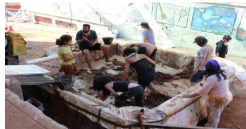
Figura 8. Fabricación de adobes en calle Balmes Figura 9 Piscina para la mezcla de la tierra
