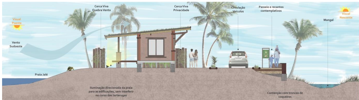
Figura 3 – Perfil transversal do terreno mostrando as relações dos Bangalôs com o entorno.
