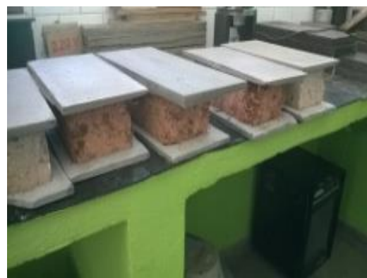
Figura 2 – Capeamento dos corpos de prova para o ensaio de compressão
