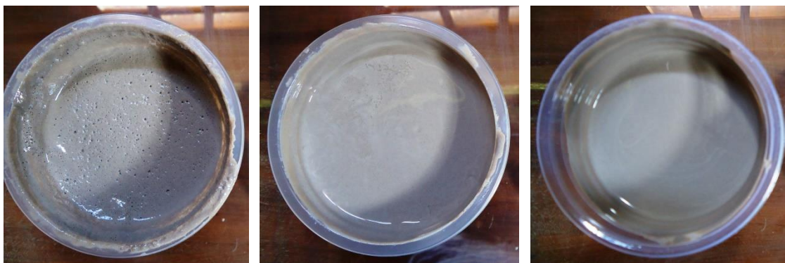
Figura 3 (esquerda) – Efeito emulsificado da amostra F03; Figura 4 (centro) e Figura 5 (direita) – Estabilidade da viscosidade das amostras F07 e F08.
