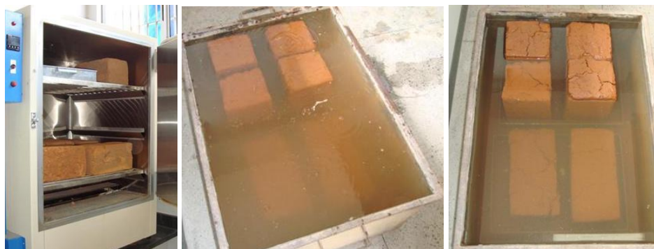
Figura 1 – Adobes em estufa para secagem; adobes recém-imersos em tanque de água e após 24 horas de imersão. Fonte: Produzido pela autora Danielle, 2012.
