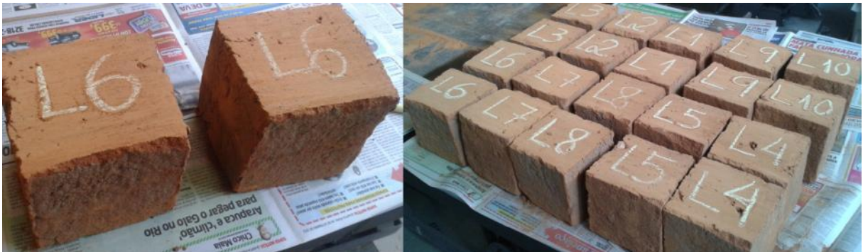
Figura 3 - Blocos cortados ao meio, devidamente posicionados e enumerados. Fonte: Vale, 2012.
