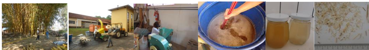
Figura 1. Procedimentos de preparo das partículas “sliver”: corte; trituração; passagem pelo moinho; lavagem; amostras antes e após lavagem e amostra de partículas para medição.
