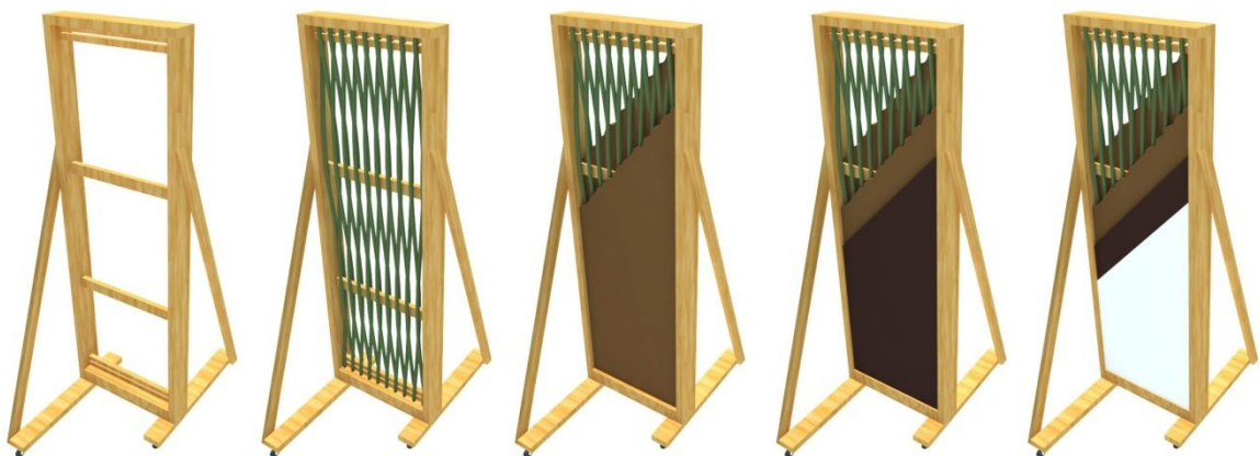
Figura 1 – Sequência esquemática das camadas constituintes do protótipo – Modelo Digital. Fonte: Acervo pessoal.
