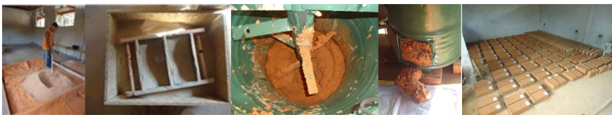
Figura 2. Produção dos adobes: homogeneização; formas; maromba e secagem.
