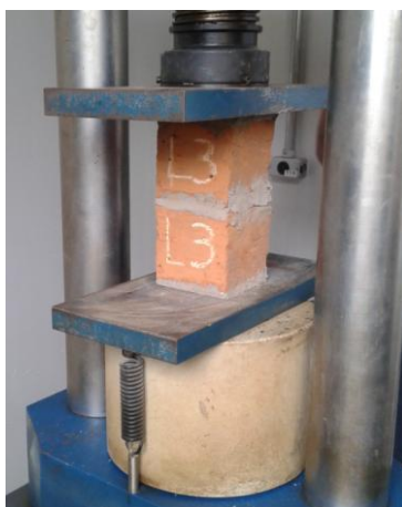
Figura 8 – Prensa de ensaio de compressão. Fonte: Vale, 2012.
