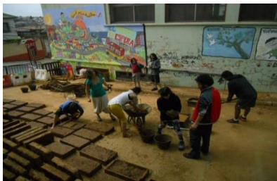
Figura 8. Fabricación de adobes en calle Balmes Figura 9 Piscina para la mezcla de la tierra
