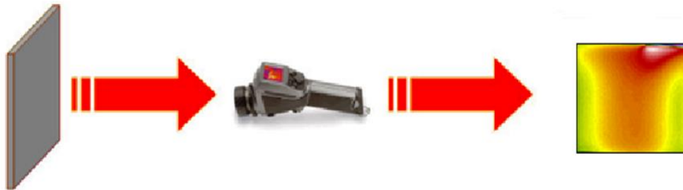
Figura 1 Esquema da geração de termogramas (Sanches, 2009)
