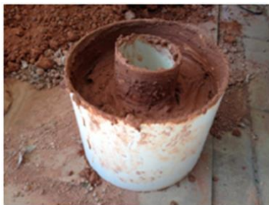
Figura 3 – Molde para construção do tijolo.
