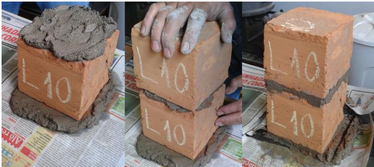
Figura 5 - Primeiro assentamento e união das metades de cada bloco. Fonte: Vale, 2012.
