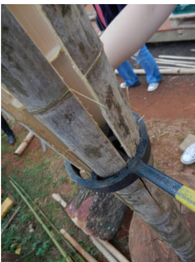
Figura 2: Corte com faca radial. Fonte: Acervo Pessoal.
