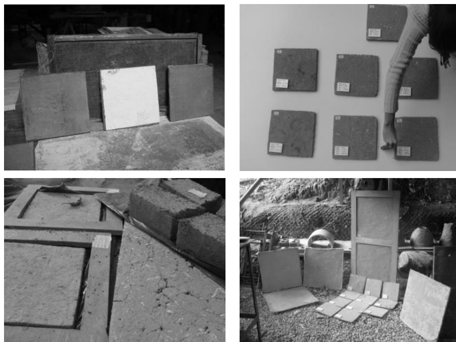
Figura 3 - Placas de fibrosolo destinadas aos processos de pré-fabricação.
