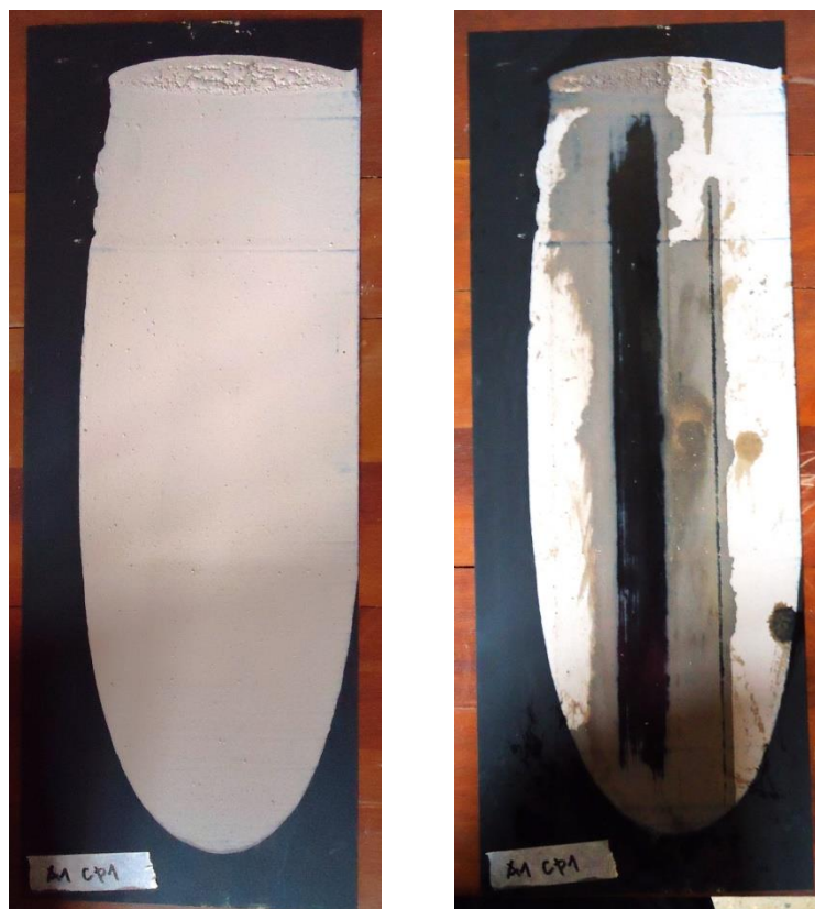
Figura 1 (esquerda) e Figura 2 (direita) – Corpos de prova antes e depois do ensaio de determinação da resistência à abrasão.
