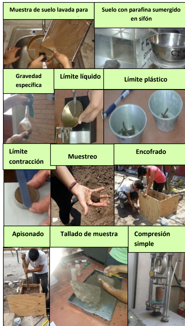
Figura 1. Ensayo de estudio del suelo.
