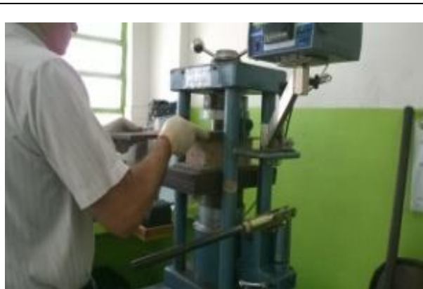
Figura 3 – Ensaio de compressão
