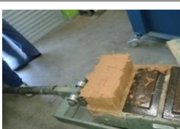
Figura 1 – Desforma do tijolo, na prensa manual
