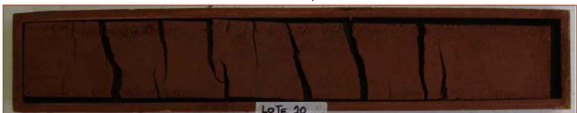
Figura 3. Imagem do teste de retração realizado no Lote 20 do Assentamento I.
