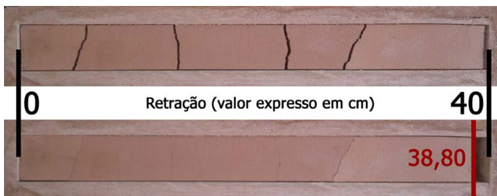
Figura 8 – Comparativa entre os ensaios de retração linear da fração argilosa da terra.
