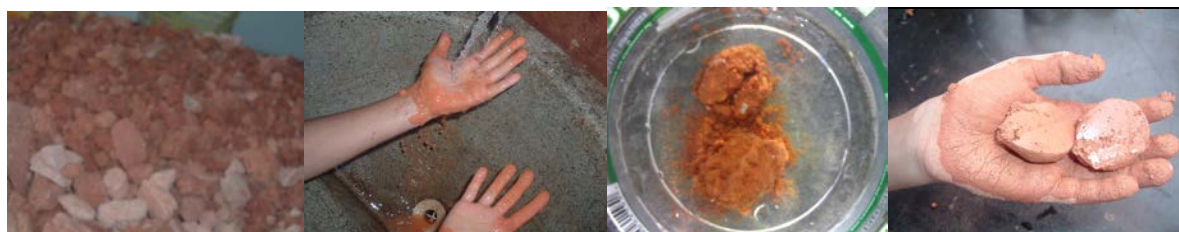
Figura 4. Torrões de solo, sujar as mãos, desagregação do solo submerso e brilho
