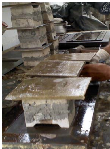
Figura 4. BTC sendo preparados para o ensaio de compressão
