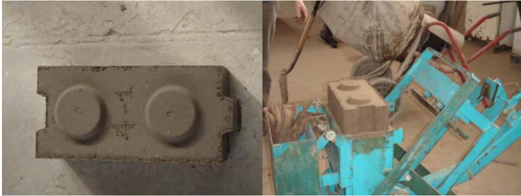
Figura 7. Bloque intertrabado y prensa utilizada para su ejecución
