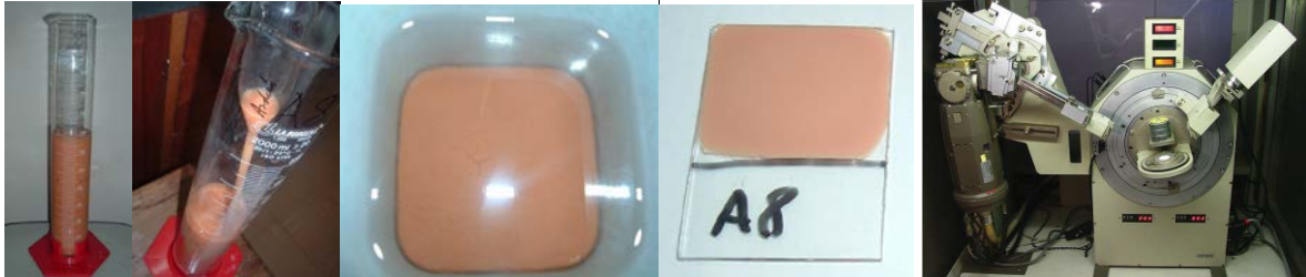
Figura 3. Separação e secagem da fração argila e imagem do difratômetro (Meneses, UFS)
