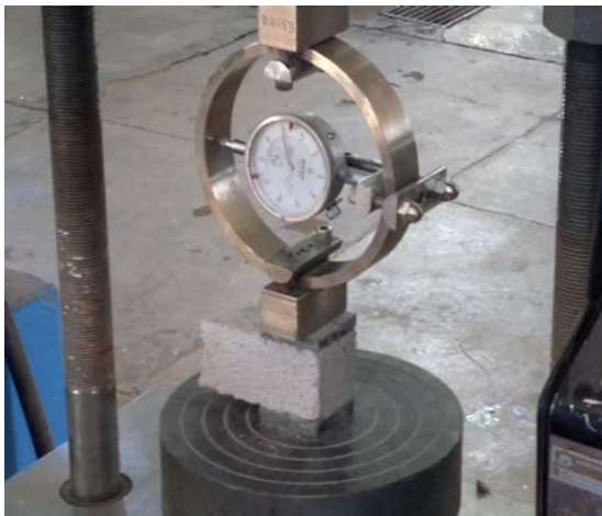
Figura 6. – ensaio de resistência à compressão Figura 7. – Ensaio de resistência à tração na flexão
