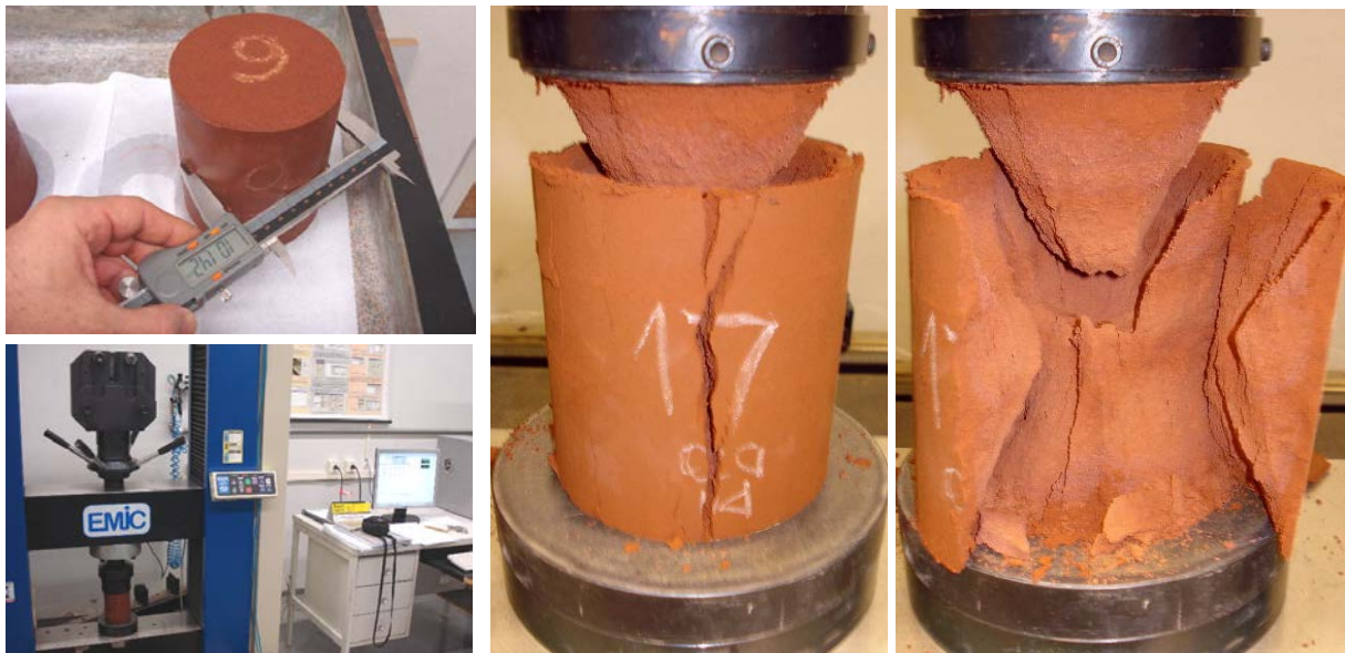
Figura 5 – Ensaio de determinação da resistência à compressão: medição do corpo-de-prova saturado; máquina de ensaios; e, padrão de ruptura, notando-se o cone de tensões, com desprendimento do material lateral e periférico, em camadas
