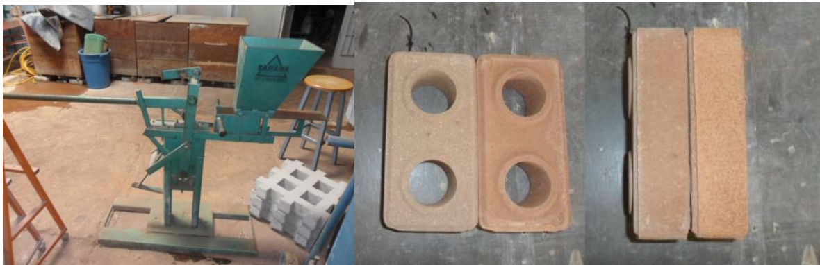
Figura 3. Fabricação dos blocos de terra comprimida de solo-cimento-fino de basalto
