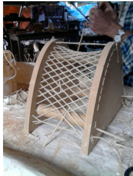
Figura 7 – Segunda miniatura com comportamento estrutural idêntico ao da construção real (Acervo do LILD, 2011)
