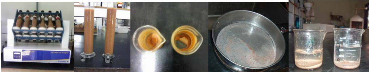
Figura 1. Agitação, sedimentação, argila seca em estufa, areia retida na peneira e transferida
