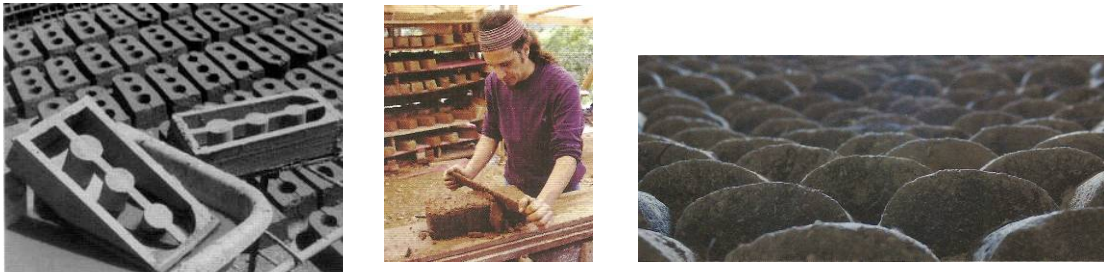
Figuras 13,14 e 15. Molde e adobes acústicos (Minke, 2007 e 2008; Ferreiro 2010)
