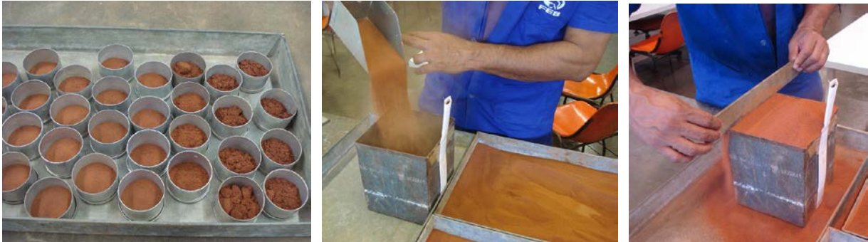
Figura 1 – Ensaio de determinação da massa unitária do solo solto úmido e da umidade higroscópica
