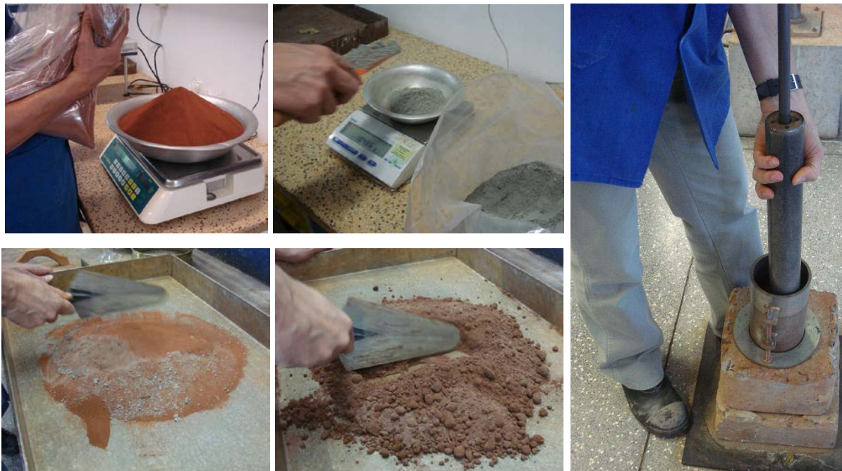
Figura 2 – Ensaio de compactação do solo-cimento: pesagem do solo e do cimento; homogeneização da mistura (antes e depois de acrescentar água); e, moldagem do corpo-de-prova
