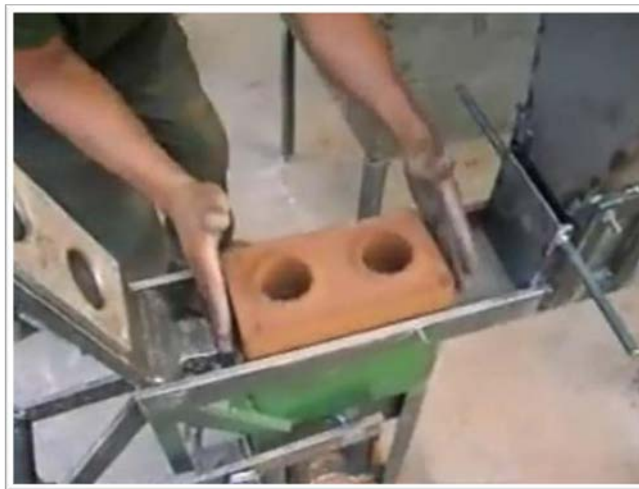
Figura 2. Tijolo de solo-cimento sendo desenformado, após prensagem manual (do autor, 2010)
