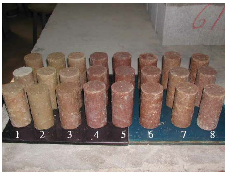
Figura 2. Corpos de prova das misturas de solo-cimento-lama de minério de ferro
