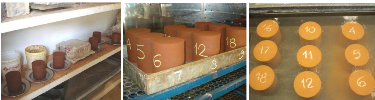
Figura 4 – Ensaio de absorção de água: corpos-de-prova na câmara úmida, na estufa e imersos em água
