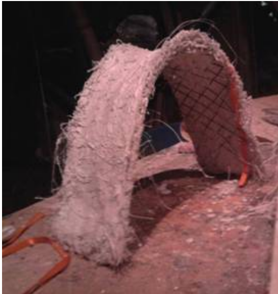
Figura 6 – Casca estrutural de gesso e sisal em escala reduzida (Acervo do LILD, 2011)
