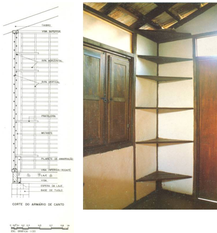
Figuras 33 e 34. Corte painel e foto armário (Silva, 1991).
