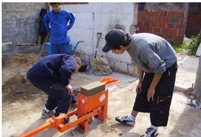
Figura 4: Capacitación a jóvenes de zonas urbanas pobres en la fabricación de bloques de suelo-cemento, Bancalari, Buenos Aires, 2006 (Crédito: R. Rotondaro)
