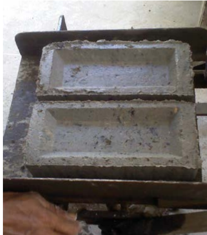
Figura 3. BTC com adição de resíduos
