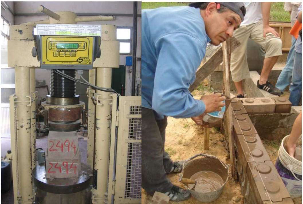
Figura 8. Ensayos de laboratorio del producto y capacitación a albañiles
