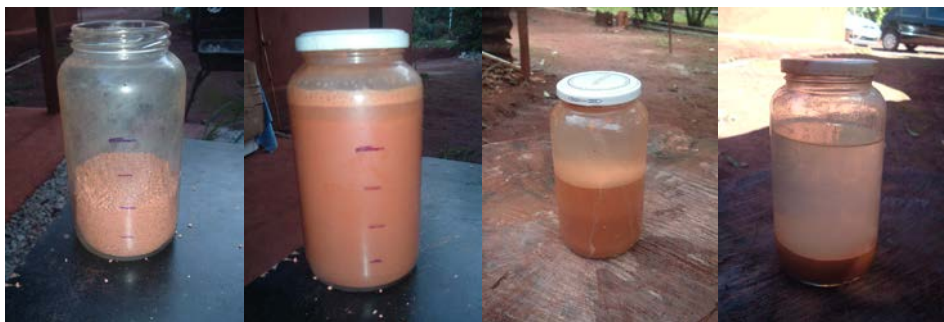
Figura 2. O solo seco e lavagens sequentes até a transparência da água
