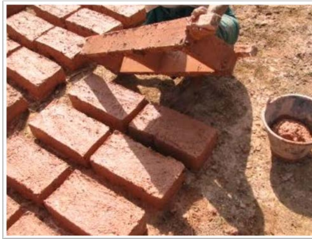
Figura 3. Blocos de adobe sendo desenformados (Picorelli, 2011).
