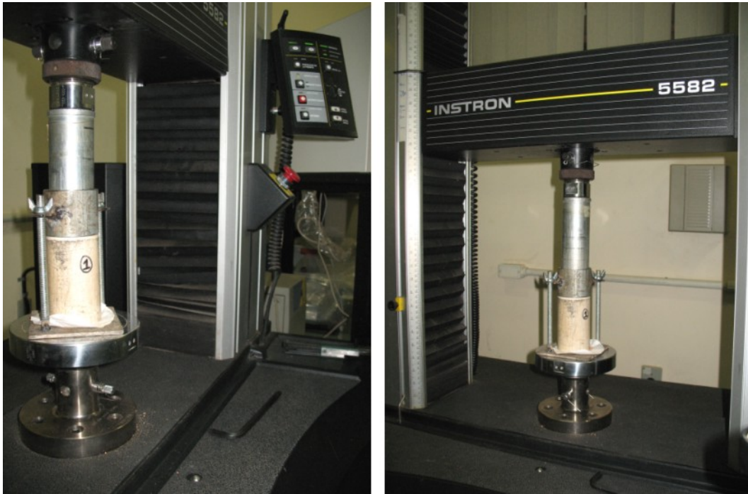
Figura 1. Dispositivo de moldagem do corpo-de-prova montado na máquina universal de ensaio
