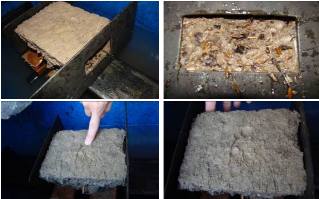
Ensayo de erosión. Estado del adobe a los 15' de ensayo
