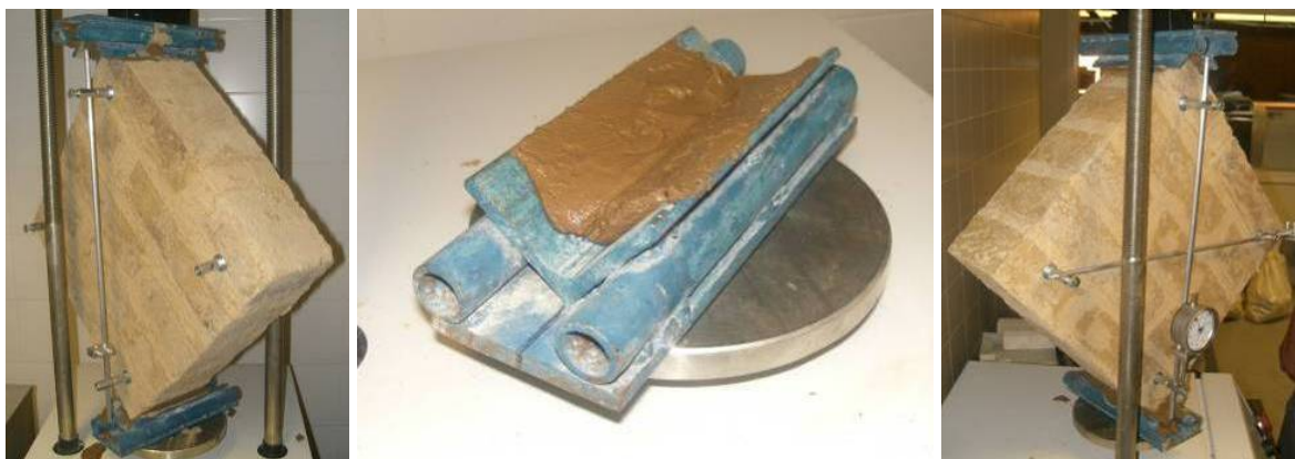
Figura 6. Colocação de argamassa de solo para melhor acomodação dos apoios metálicos responsáveis pela distribuição dos esforços de compressão
