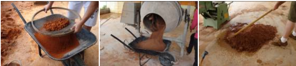
Figura 4. Etapas do processo de mistura ou homogeneização: peneiramento, homogeneização e homogeneização da mistura úmida
