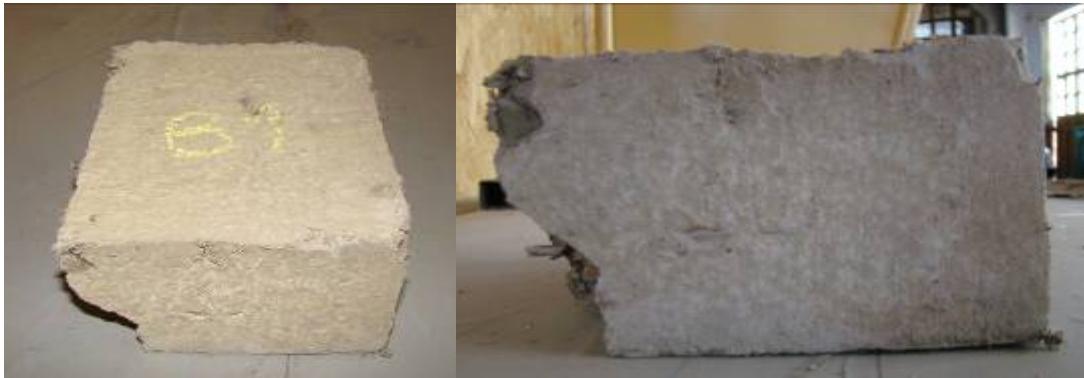
Ensayo de erosión. Estado original del adobe
