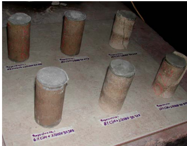
Figura 2. Corpos-de-prova de solo-cimento-DS328® após ensaio de compressão simples
