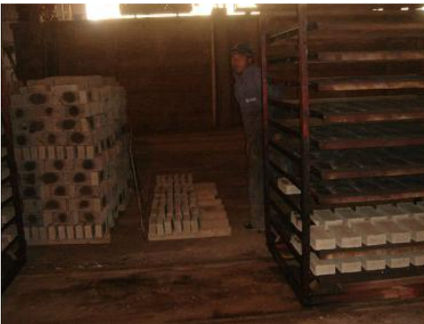
Acopio y espera a la entrada al secado
