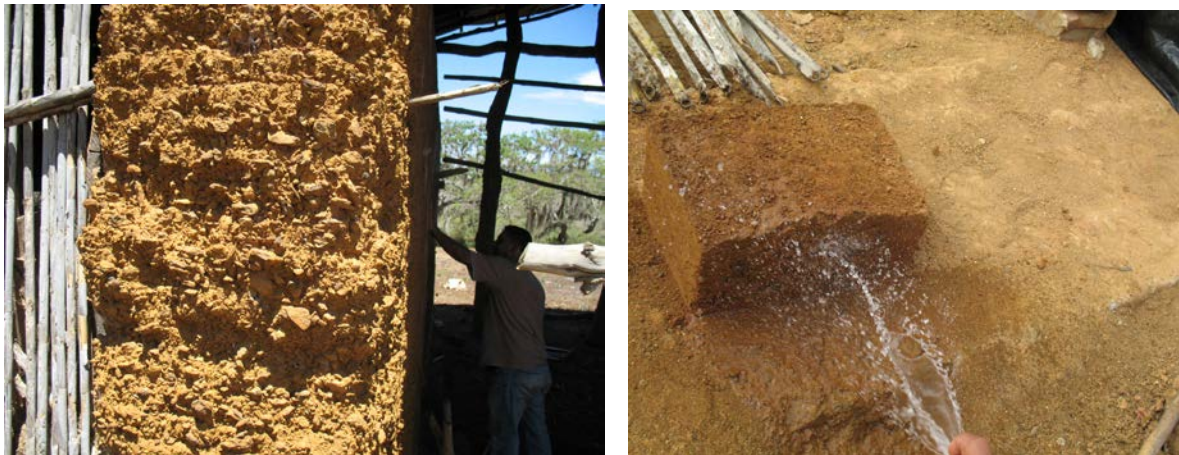
Figura 4. Haciendo experimentos de campo con la granulometría encontrada en las construcciones más antiguas de la región
