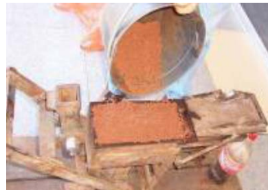
(b) Carregamento da caixa de moldagem
