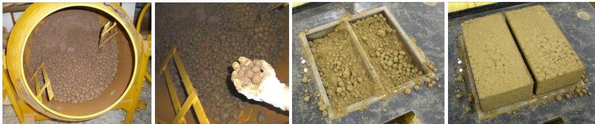
Figura 2. Mistura do Kraftterra em uma betoneira com formação de aglomerações
