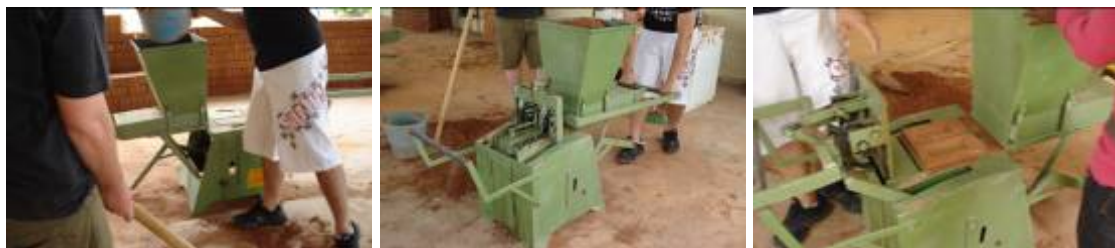
Figura 5 – Processo de prensagem dos blocos de terra comprimida – Abastecimento da prensa com a mistura de solo-cimento e prensagem
