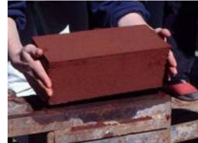
(d) Retirada do bloco moldado
