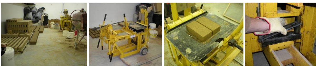
Figura 3. Prensa TERSTARAM. Detalhe do sistema de ajuste de altura do molde (direita)
