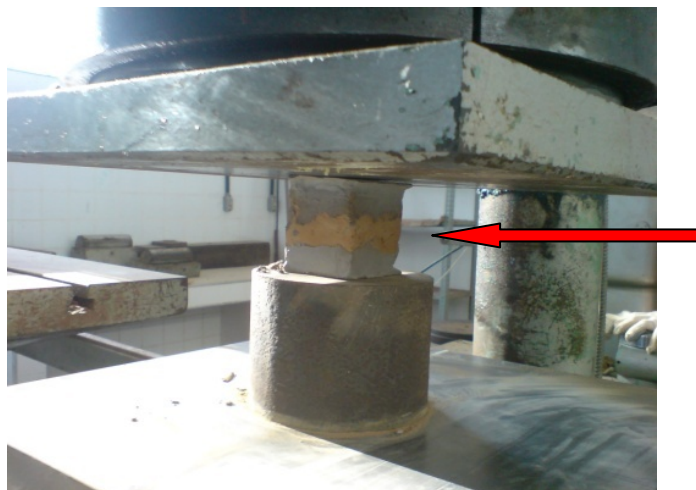
Figura 2. Ensaio de compressão de corpo-de-prova cúbico com 7 cm de aresta, segundo as recomendações PROTERRA
