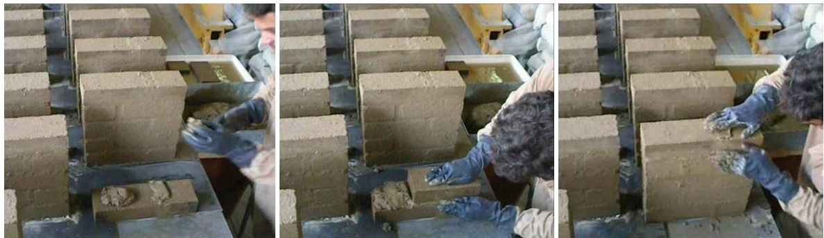
Figura 4. Execução de prismas com BTCs e argamassa de assentamento de Kraftterra feitos com as mãos, sem o uso de colher de pedreiro. Detalhe da imersão dos BTCs em água (esquerda)
