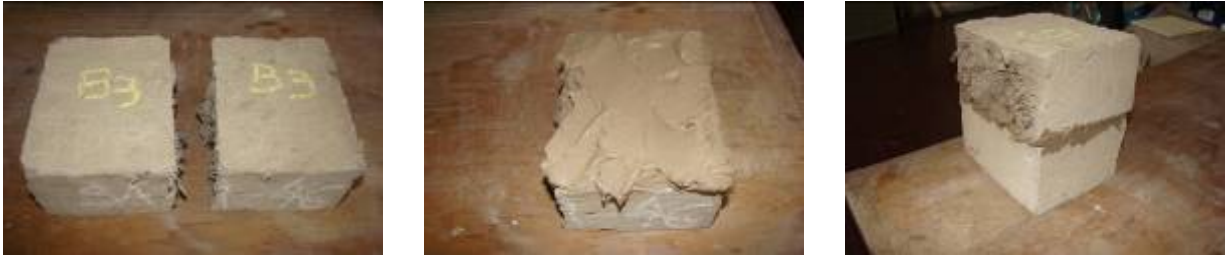
Ensayo a la compresión
