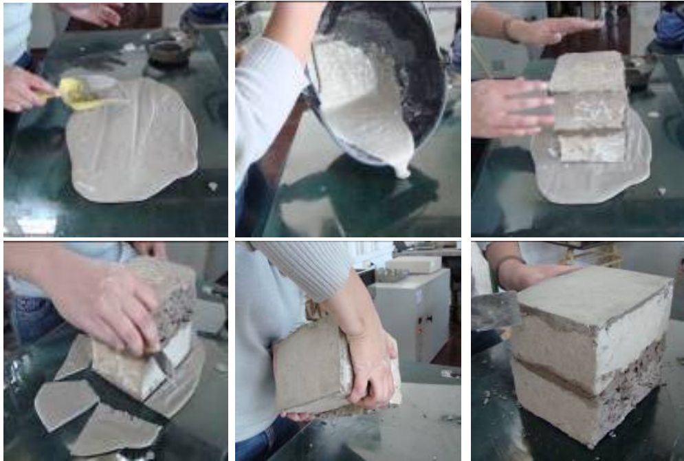
Preparación de los adobes para ensayo a compresión
