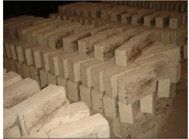
Acopio de adobes
