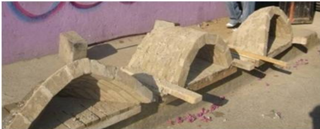
Prueba de adherencia y muestras de diferentes tipos de bóvedas
