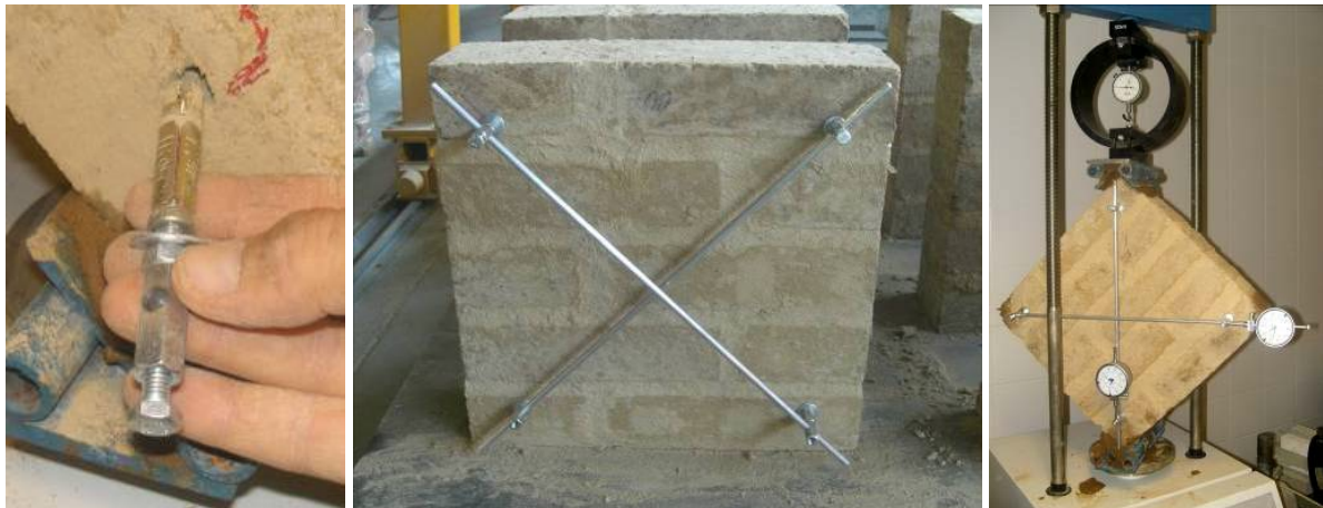
Figura 5. Sistema de fixação de barras e apoios para extensômetros em prismas para realização de ensaios de compressão diagonal
