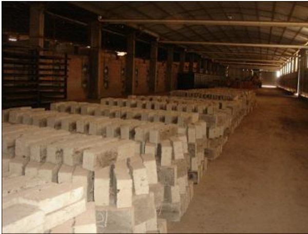
Adobes y túnel de secado
