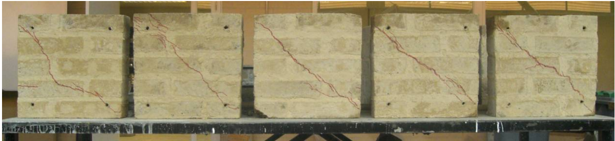
Figura 9. Prismas ao final de ensaios de compressão diagonal. As linhas de fissuras foram ressaltadas com tinta vermelha diretamente nos prismas
