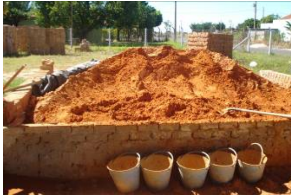
Figura 3. Solo utilizado para a produção dos blocos de terra comprimida de solo-cimento
