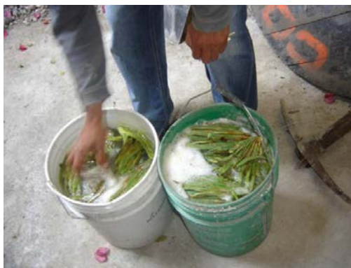
Tratamiento del mucílago de nopal para proceder a impermeabilizar
