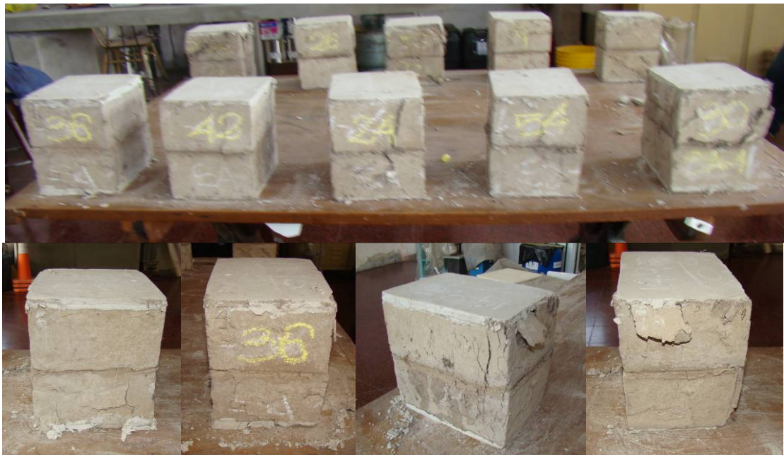
Estado de los adobes después del ensayo a compresión
