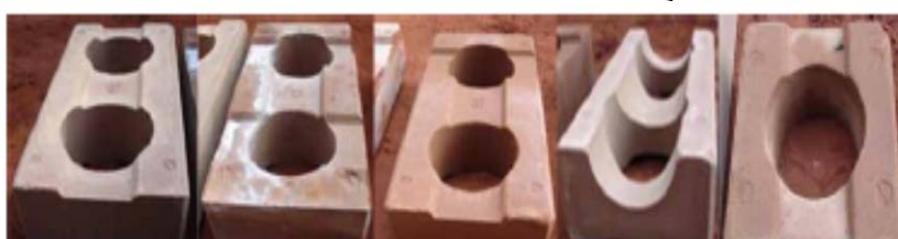
Figura 3. Blocos BTC vazados, com formatos diferenciados pelo tipo de utilização na parede. Da esquerda para a direita, blocos dos tipos reto, coluna, canto, canaleta e meio bloco
