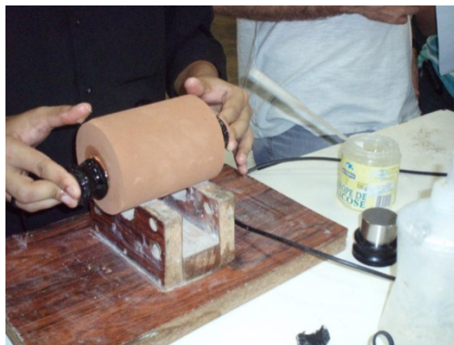
Figura 1 – Ensaio de ultrassom utilizando transdutor de onda transversal de 1MHz
