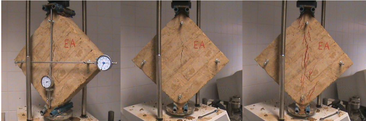
Figura 11. Prisma de Kraftterra que passou por ciclos de envelhecimento acelerado após ensaio de resistência à compressão diagonal
