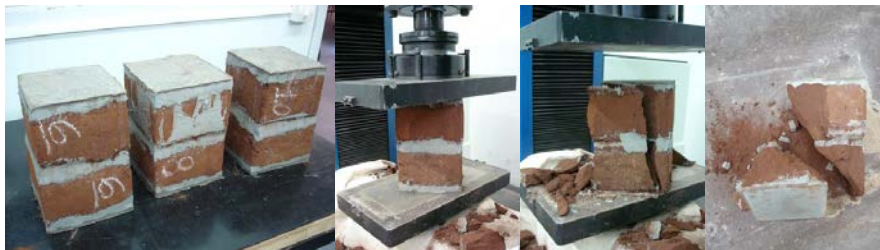
Figura 3. Ensaio de resistência à compressão (Fonte: Obede Borges Faria, 2006)
