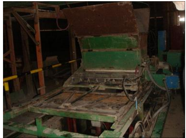
Máquina extrusora y conformadora de adobes
