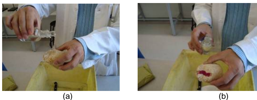
Figura 4. Análisis con el método de la fenolftaleína (a) Corte superior a la probeta (b) aplicación de la fenolftaleína. Fuente: Alumnos MPT y C
